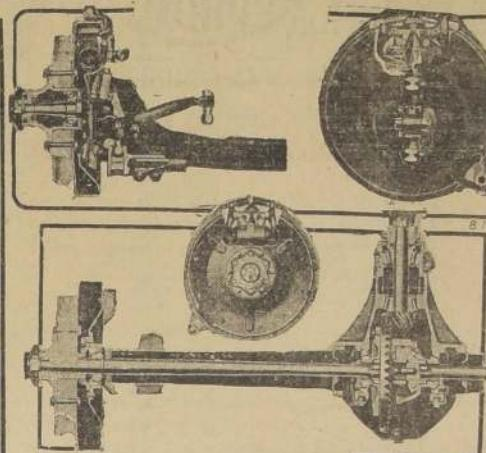
pietario se relaciona, bastemos decir que ambos sistemas exigen menos presión del pedal para frenar, porque la rotación de las ruedas ayuda a formar una fuerza adicional a la que se produce con la presión del pedal de los frenos.
