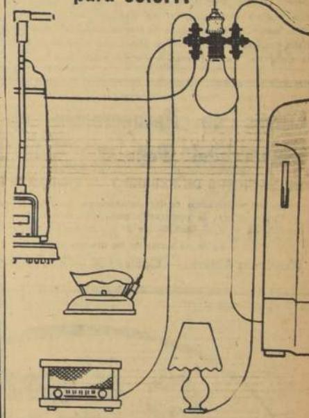
Al exigir a su instalación, más de lo que ésta puede rendir, Ud. obtiene menos aprovechamiento útil de la electricidad que consume... Paga por energía que se pierde en el recalentamiento de los cables y pone en peligro su instalación y su casa... Para eliminar peligros y sacar mejor provecho de la energía que Ud. consume... consulte a un técnico autorizado.
