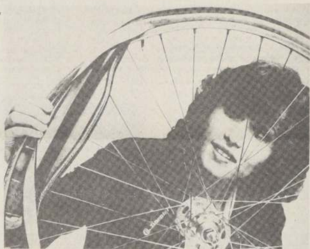
TUBULARES CON CREMALLERAS. Este tipo de neumático de competencia ciclista con cierre facilita la reposición de un modo inesperado. El nuevo tubular de 200 gramos marca "Conti" no está cosido, como hasta ahora, sino que se le puede abrir con una amplia cremallera. Una sencilla maniobra y el tubular está listo. Después de arreglar la avería, el neumático se encuentra en el acto en su posición original. El tubular ha sido presentado por primera vez como novedad en la exposición internacional de la Bicicleta y Motocicleta (IFMA) en la ciudad de Colonia que llamó poderosamente la atención en la República Federal de Alemania.
