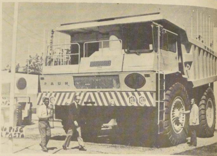
Entre las grandes maquinarias que se exhiben en la Feria de Cerrillos figura este gigantesco camión tolva de 85 toneladas de capacidad. Los neumáticos miden 2 metros y medio de altura. De este modelo hay sólo 6 unidades operando en el país.
