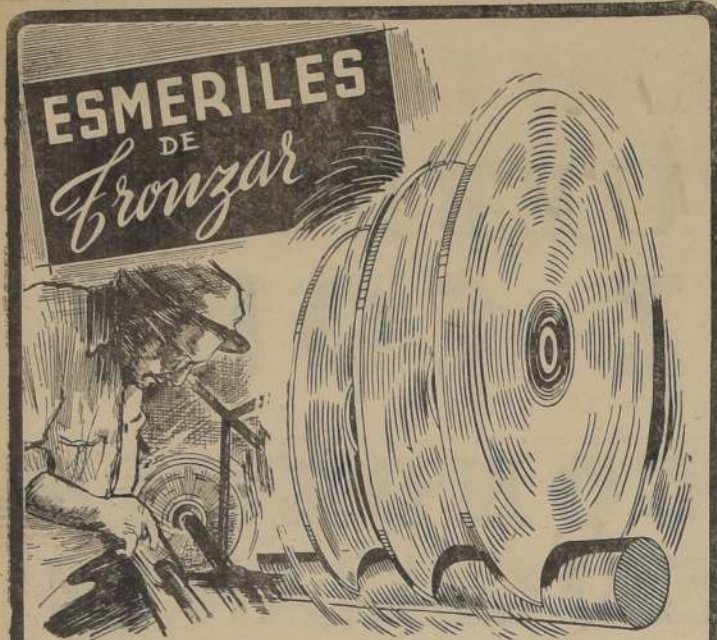
ESMERILES PARA TRONZAR FIERRO ANGULAR; TUBOS EN GENERAL, BARRAS DE FIERRO, ACERO, BRONCE, ETC.
