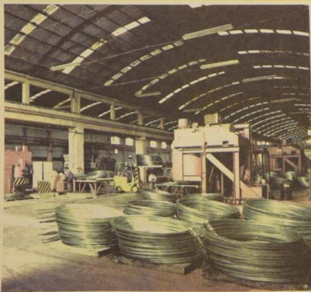
LAMINACION de rollos de cobre, aluminio, y latones, para la producción de radiadores de automóviles, ampollas, artefactos electro-domésticos e industrias varias.
