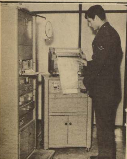
Esta máquina recoge las emisiones que lanzan uno de los satélites meteorológicos para convertirlos en fotografías que ayuden a detectar los sistemas de mal tiempo.
