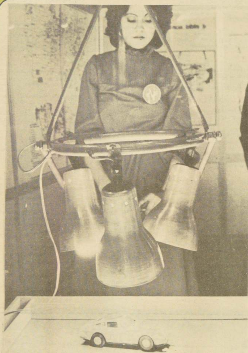
Tres ampolletas de 1000 watts dan la luz necesaria para mover el auto de juguete. Dos celdas fotovoltaicas, de unos cinco centímetros de diámetro, transforman la energía de la luz en energía eléctrica.
