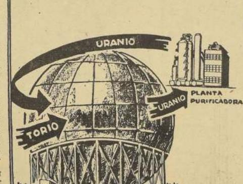
Dentro del "reactor de incubación" el metal torio entra a un área que rodea el centro de este gigante aparato. Los neutrones del núcleo transmutan al torio en una forma de uranio fisionable (U-233). El vapor canalizado desde el reactor genera electricidad. El uranio del reactor es purificado en una planta química. Después sirve de combustible para aviones, trenes o buques atómicos. Una pequeña parte de él sigue alimentando al reactor incubador.
