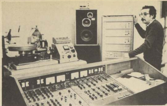
Una consola inglesa de transferencia de 4 canales y un amplificador impulsor de corte, de procedencia alemana, incorporó a su sala de corte de discos el sello EMI Odeón. Los equipos mejoraron la fidelidad y potencia en la producción fonográfica. Su debut será el primero de septiembre próximo y estará a cargo del ingeniero de sonido, Hernán Siviragol (en la foto).
