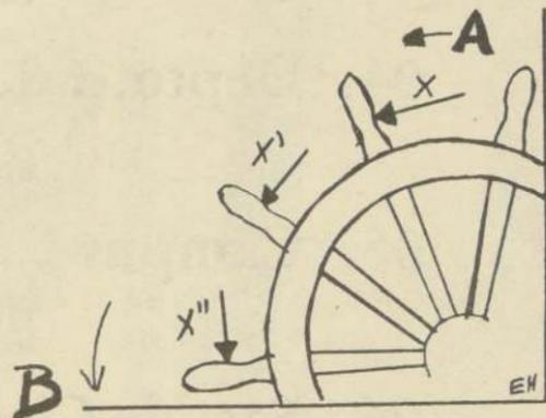
Si el timón se va a mover desde el punto A al punto B, usted debe hacer un movimiento aplicando la fuerza como muestra la flecha X. Cuando el timón va en el punto B, la fuerza aplicada debe tener la dirección X'.
