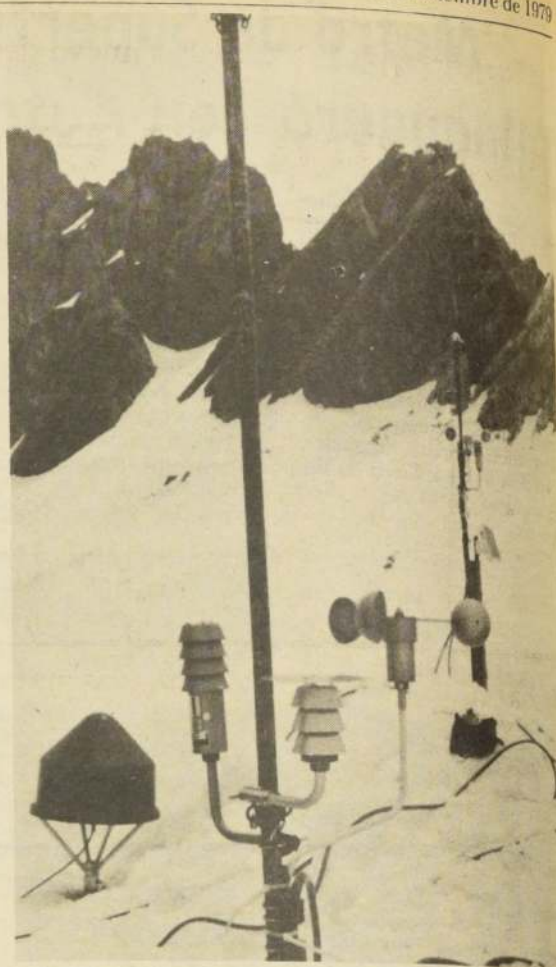
EN LA ALTA CORDILLERA la plataforma está enterrada bajo la nieve y permanecen en la superficie sólo los sensores y la antena.
