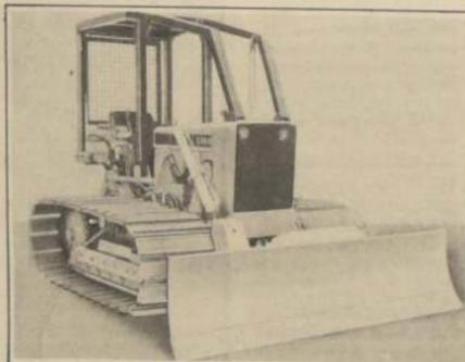
Diseñado para trabajar en las bodegas de los barcos, este tractor-oruga 350B HF de JI Case ya opera para varias empresas del país. Sobresalen su hoja de empuje de alta flotación y su bajo peso.
