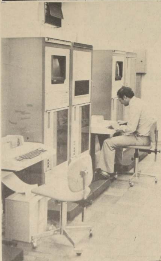
Con este computador instalado en la Compañía de Teléfonos de Chile se controlará la duración y el número de llamadas telefónicas al ponerse en práctica el Servicio Local Medido.
