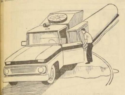
El agente espumante, mezclado con agua, dentro de un "Proporcionador" que es lanzado a los incendios mediante una enorme manguera de nylon, con sorprendente buen resultado.
