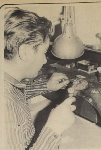
PARTE DEL PROCESO: El soldador junta las piezas que formarán el anillo.
