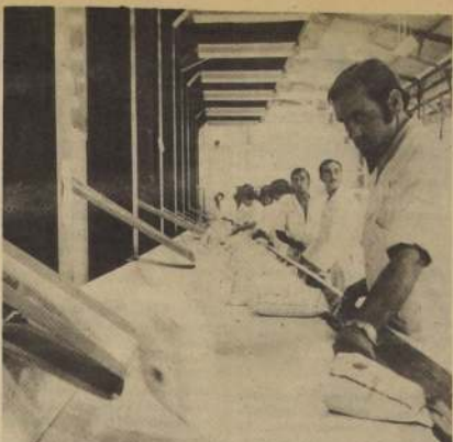
LOS TRABAJADORES y técnicos de la nueva Planta Envasadora de leche ubicada en los terrenos de SOLECHE, en plena faena de trabajo. Ocho unidades altamente mecanizadas elaboran las bolsas y las llenas del producto, el que es transportado también mecánicamente hacia el lugar de almacenaje.
