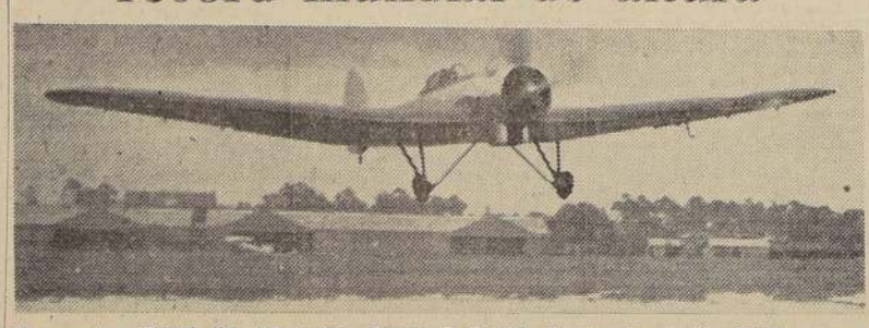
El monoplano Bristol, tipo 138 (motor Pegasus F. E. VLS. de sobrealimentación doble), a cuyo bordo, el jefe de escuadrón F. R. D. Swain, ha establecido un nuevo record mundial de altura de 15.230 metros. Aquí se ve el aeroplano despegando para un vuelo de prueba.
