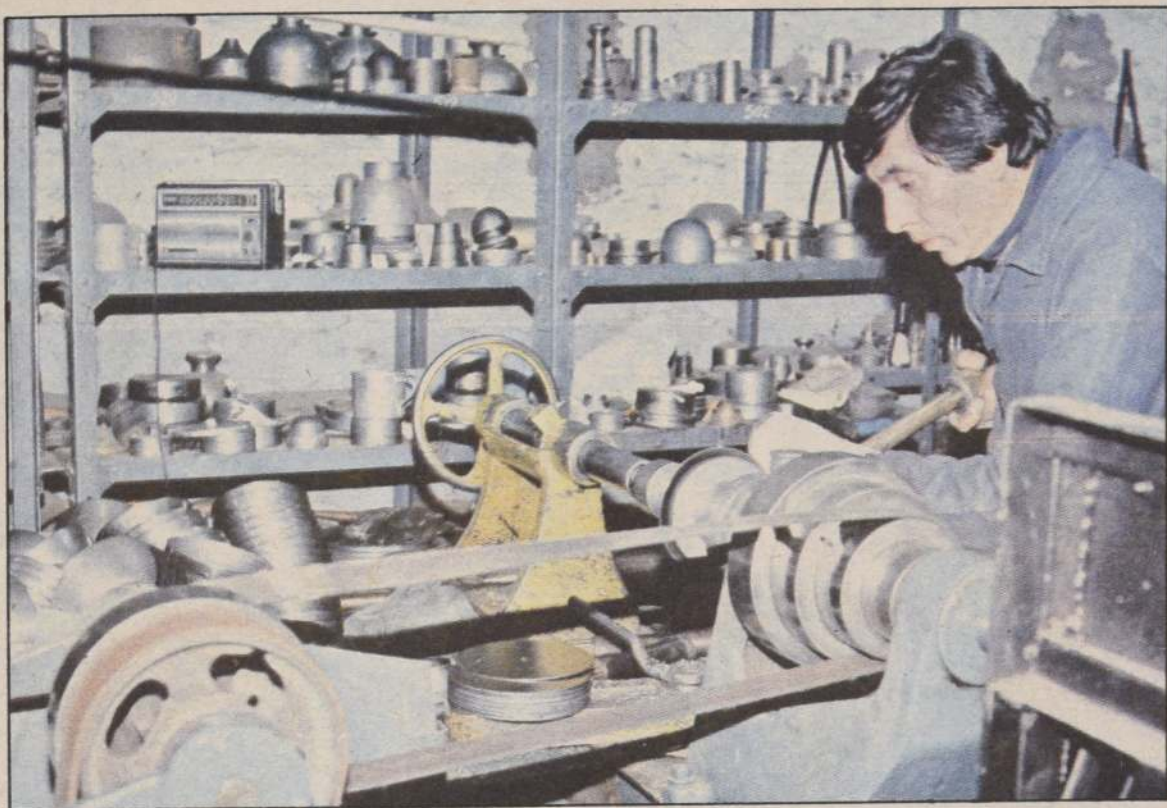
La sección del torno donde se efectúa el repujado de los materiales para darles la forma definitiva a las pantallas de escritorio, es una de las tantas áreas de la industria que fabrica estos artículos en una amplia gama de modelos y dimensiones.
