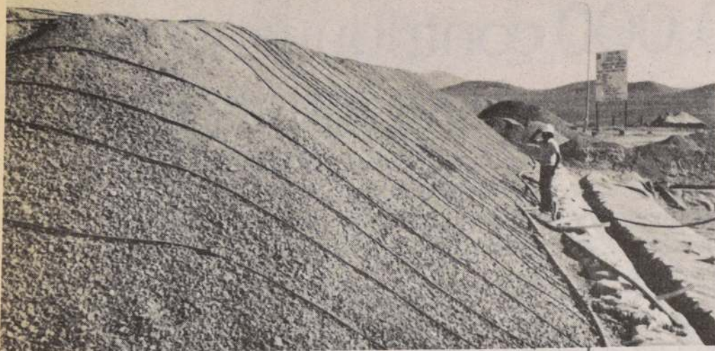
Faenas de lixiviación bacteriana, nueva técnica que CORFO traspasa a los pequeños y medianos mineros para extracción de cobre en forma sencilla y rentable.
