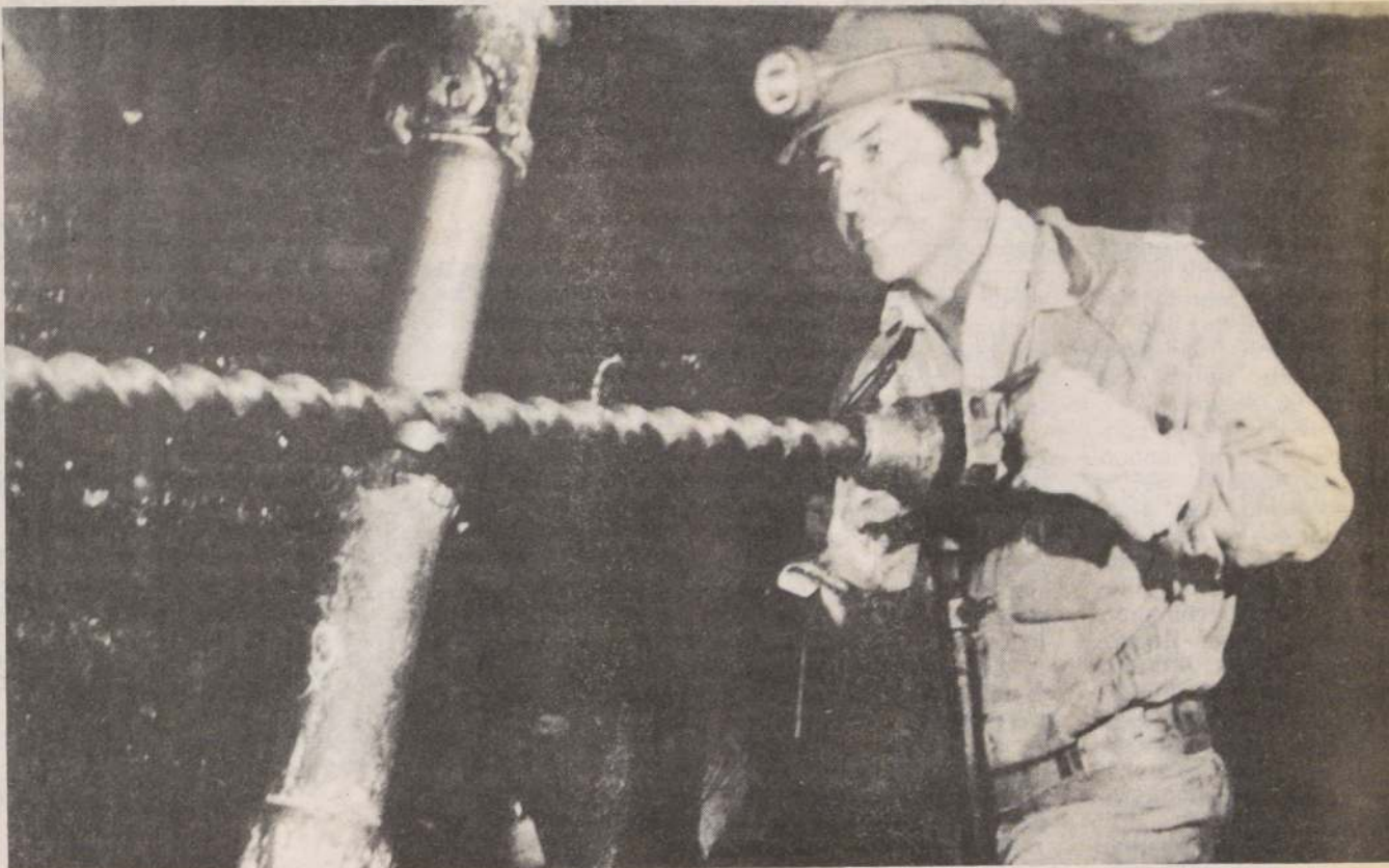
Un minero operando un taladro en uno de los piques. La mecanización está presente en la labor de la minería del carbón. Para este año se proyecta aumentar la imple- mentación de equipos para apertura de galerías, además de sistemas de transporte, ventiladores, transformadores eléctricos, etc.
