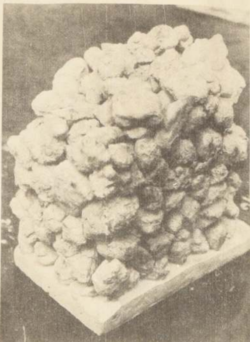
Los hormigones livianos han servido en otros países para levantar desde un puente hasta un frágil muro divisorio. En Chile, el IDIEM ha elaborado con gran éxito una mezcla semejante. EN LA FOTO: Arcillas expandidas, elemento base de este nuevo tipo de concreto, obtenidas en una planta piloto de Maipo.
