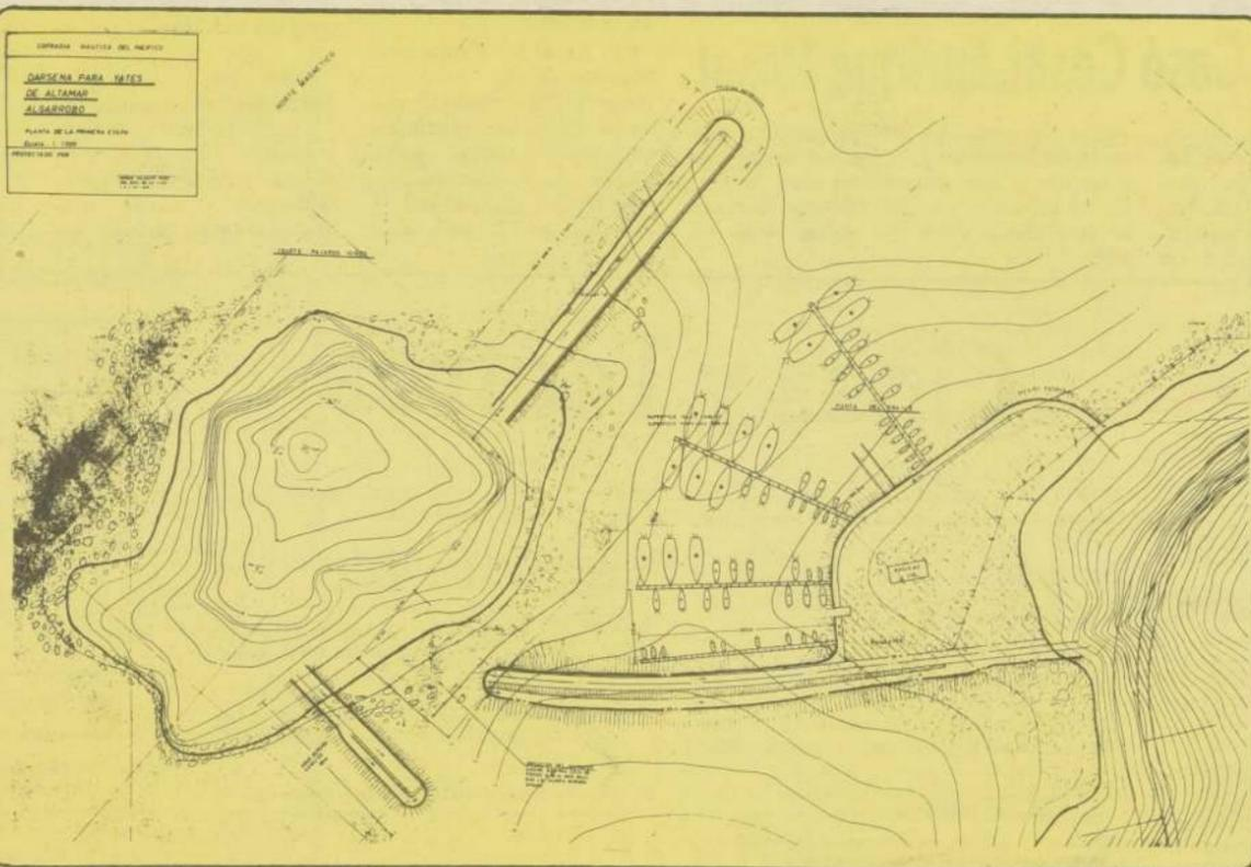
El plano de la Cofradía Náutica del Pacífico, proyectado por el Ingeniero Civil Sergio Culaciati Ríos, muestra la planta de la primera etapa de la dársena para yates de alta mar ubicada en el islote de los Pájaros Niño, de Algarrobo. Se aprecian los tres molos, que no se tocan entre sí y que permiten el libre flujo y reflujos de las mareas, por lo cual no se afectará la ecología de esa zona del litoral.
