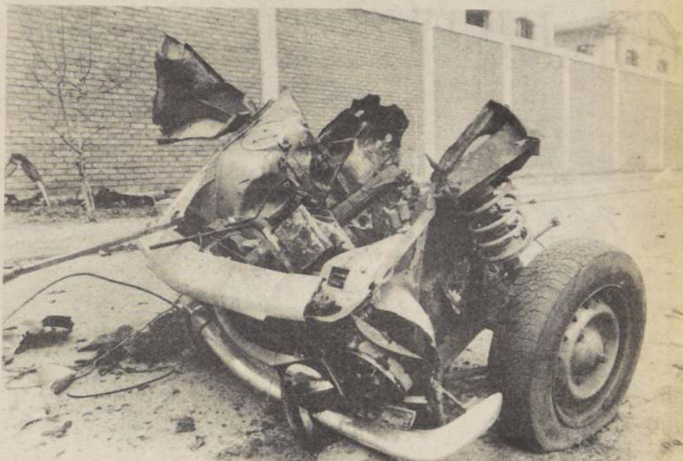
En la parte delantera del auto, bajo el asiento del copiloto, fue ubicado el artefacto explosivo, que dividió el coche y lanzó la caja del motor a una distancia de diez metros del lugar de la detonación.
