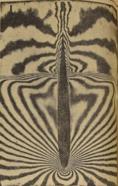
UN MILLONÉSIMO DE SEGUNDO. — La cámara fotográfica copió este diseño, perfectamente simétrico, del aire en un modelo aéreo, en un túnel de viento, a la velocidad de 100 metros por segundo. La fotografía se obtuvo en el Laboratorio Nacional de Física de Gran Bretaña. — (Foto Bippa).
