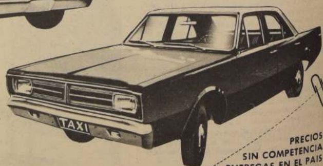
DODGE TAXI. Modelo fabricado especialmente para servicio público. Motor económico, 6 cilindros, 137 H.P. igual al Dodge Dart. Opcional, Motor Diesel 71 H.P.
