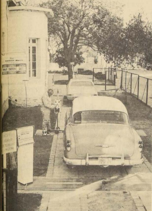
EL MAS MODERNO Y NECESARIO EQUIPO DE INSPECCION DE VEHICULOS pondrá en servicio el AUTOMOVIL CLUB de Chile. Se trata de dispositivos mecánicos que establecen el desgaste de los neumáticos, la alineación de la dirección, la intensidad de las luces de los faros delanteros y su retroceso, y el estado de los frenos en cada una de las ruedas del vehículo. El sistema será exhibido a las autoridades y a la
