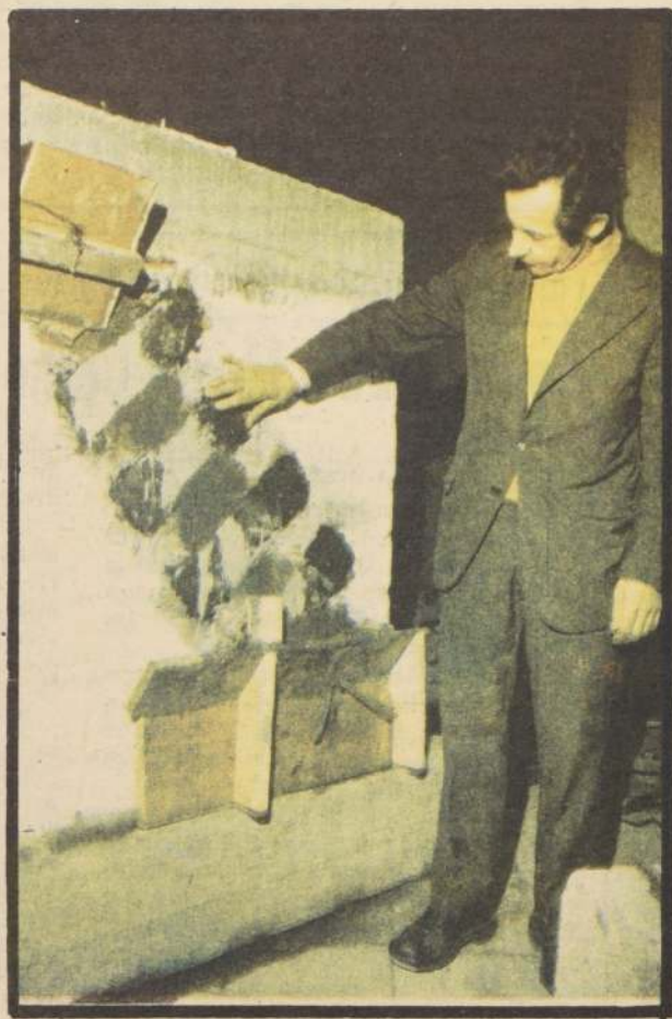
El ingeniero Ernesto Gómez, del IDIEM, muestra un ensayo para reparar murallas de ladrillos, afectadas por un temblor, con planchas de acero fijadas con adhesivo. Es uno de los tantos estudios emprendidos por este Instituto dependiente de la U. de Chile.
