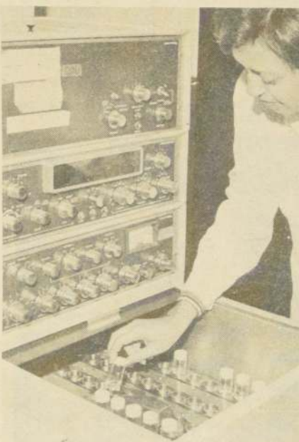
Contador de Radioactividad tipo centelleo, para carbono 14 y tritio en un medio líquido. Este equipo está incorporado al Laboratorio de Bioquímica.
