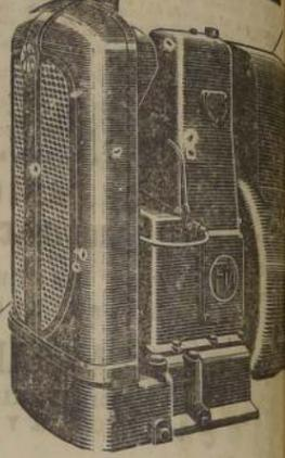
El Diesel Fairbanks-Morse de 5 1/4 H.P. es un motor vertical, manifiático, de cuatro tiempos, de fuerte y sólida construcción, con lubricación por presión.
