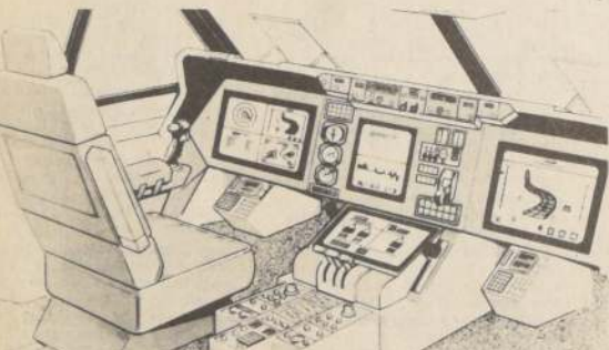
Así será probablemente la cabina de los aviones del futuro, según los técnicos de la Lockheed-Georgia Company. El piloto podrá hablar a la computadora ordenándole que muestre en las pantallas, tanto la ruta como los mapas y las condiciones atmosféricas durante el trayecto, y pedirle que haga cambios si lo considera necesario. (CPS).
