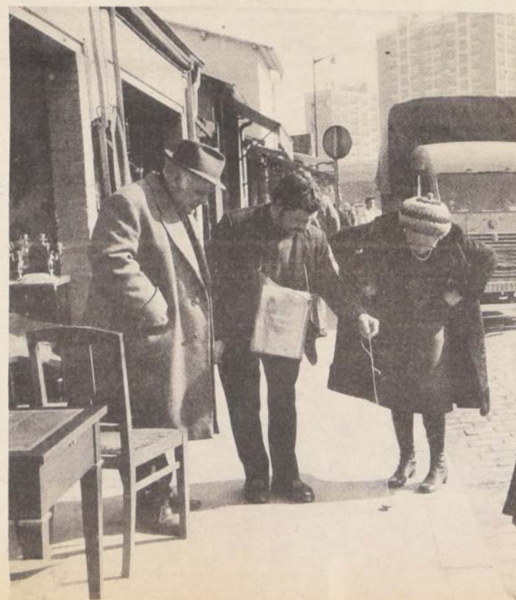
El "hydrosol", que sirve para auscultar las cañerías de agua.
