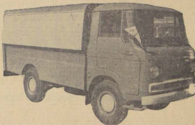
FURGON "ISUZU" 2.000 KILOS DE CARGA UTIL, CARROCERIA FRANKLIN, MOTOR DIESEL 12 H. P., 5 NEUMATICOS 750 x 15 DE 10 TELAS. CAJA DE CAMBIOS DE 4 VELOCIDADES SINCRONIZADAS. RENDIMIENTO NOMAL 15 KILOMETROS POR LITRO.
