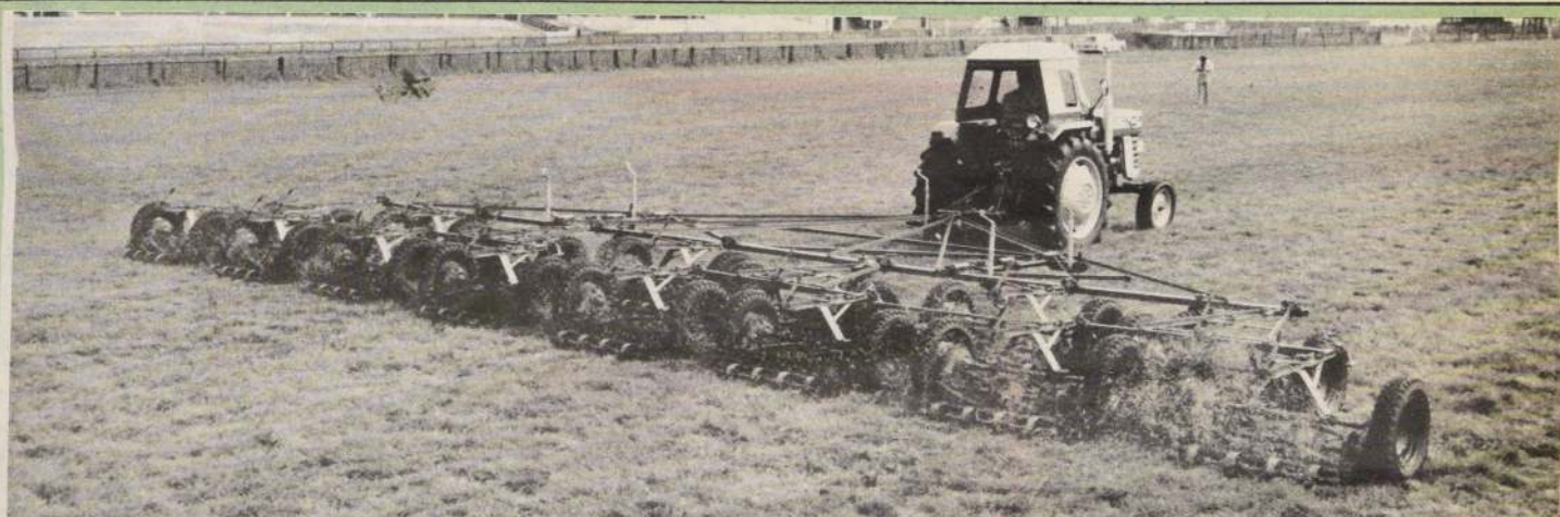
A una velocidad de 16 hectáreas por hora funciona esta segadora de césped, la máquina más grande, con 13 metros de ancho y construida por Lloyds, de Letchworth, en Londres.
