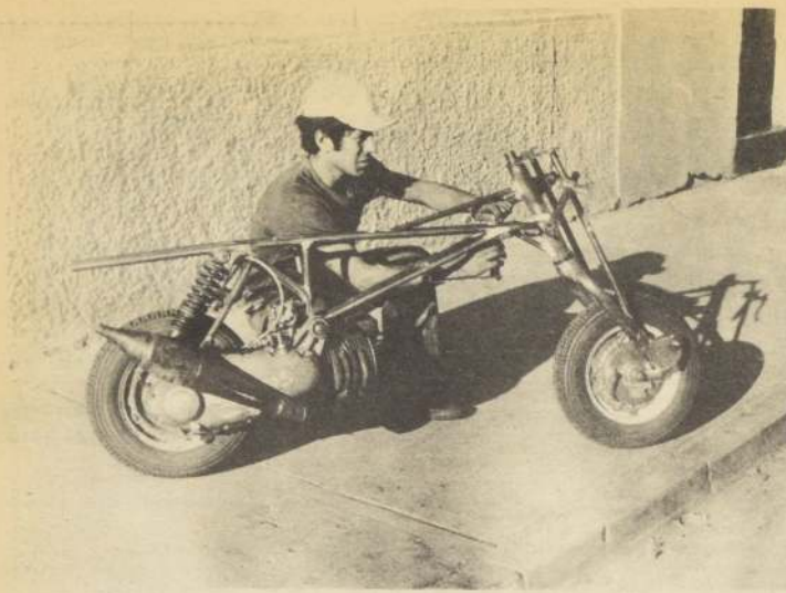
LA EXPERIENCIA: un adelanto en la mecánica nacional es la nueva construcción del chasis de alta velocidad y motor recondicionado de motoneta Lambretta, fabricados por SAMOS.
