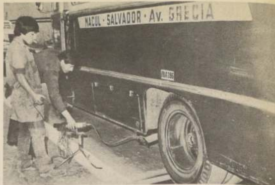
La prueba de humo se obtiene con los gases que expelen la máquina a través del tubo de escape, mientras acelera y disminuye la velocidad, tal como si estuviera en marcha. El resultado de ella se marca en un papel filtro que indica la toxicidad del gas emanado por el vehículo.
