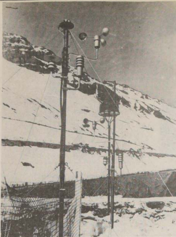
Estación de "sensores remotos" ubicada en la alta cordillera. Este instrumento es utilizado por los expertos de la Dirección General de Aguas del MOP para medir el potencial hídrico.
