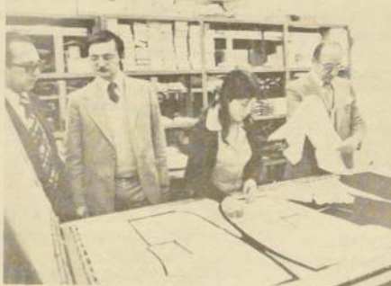
Roberto Scappini y Lorenzo Cassano controlan el trabajo de la operaria a cargo de la máquina termo fusionadora. Esta tela o fusionada, reemplaza a los antiguos rellenos.
