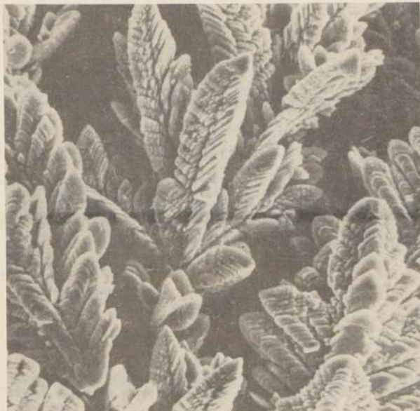
¿FOLLAJES? ¿Helechos fosilizados? En realidad, las hermosas plantas cristalizadas que creemos ver no son tal, sino partes de un microscópico cristal de zinc dendrítico amplificado nada menos que un millar de veces. Estas amplificaciones se hacen en los laboratorios de Lockheed Missiles and Space Company para detectar fallas y controlar la calidad de los materiales que se usan. (CPS).
