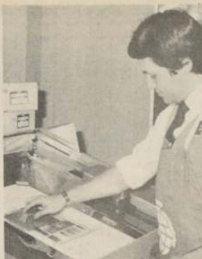
La procesadora automática Cromalith 24-L realiza todas las etapas del procesamiento de películas.
