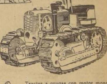
Tractor a orugas con motor monocilíndrico a "Cabeza Caliente", de 55/60 HP., extremadamente económico, con 5 velocidades de avance y 2 de retroceso.
